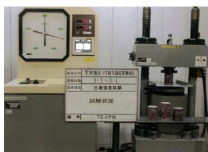
【圧縮強度試験の状況】
