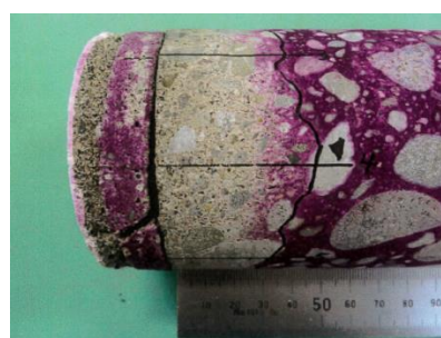
【中性化試験の状況】
