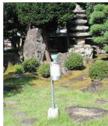
写真. 水のがっこうに設置された降水採取装置
