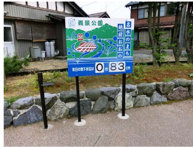
[ 義景公園観測井 地下水位表示板 ]
