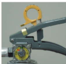
× 安全栓の抜けかけ
