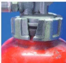
× キャップの破損
