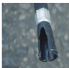
× ノズルの破損
