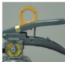
× レバー支えの脱落
