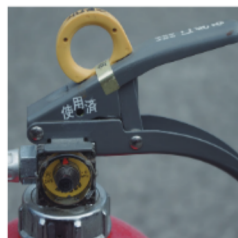
× 表示装置の脱落
