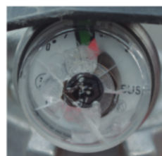
× 指示圧力計の損傷
