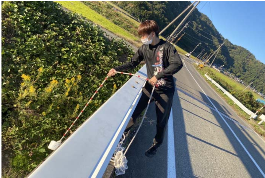
写真 3.2 赤根川上流にて錘付きロープを用いた測定の様子
