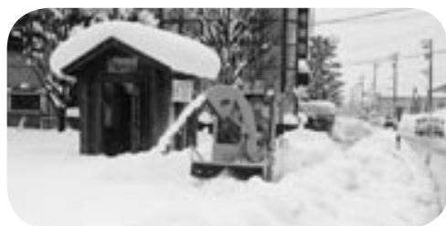
歩道を除雪する小型除雪車
