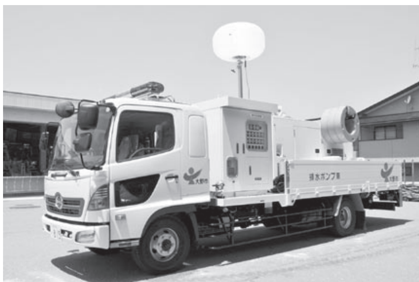
排水ポンプ車の荷台にある円筒状の浮き輪に水中ポンプを設置して水に浮かし、ホースで排水する。夜間の作業もできるように、ちょうちん型の照明装置を高く伸ばすことができる。
