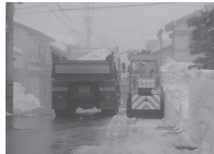
小型除雪車による除排雪
