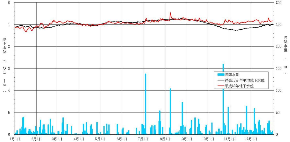
[ 平成 29 年地下水位変動グラフ 水落観測井 (NO. 8) ]
