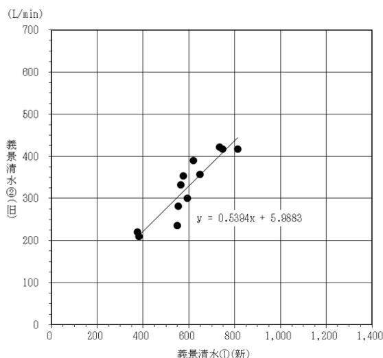
義景清水の実測流量の比較
