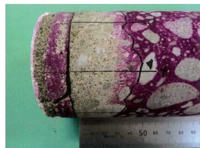
【中性化試験の状況】
