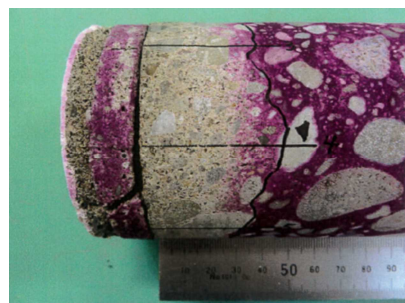
【中性化試験の状況】
