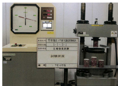
【圧縮強度試験の状況】
