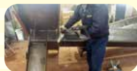
製品検査 超音波探傷検査で製品を厳しくチェックします。
