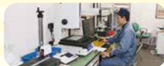
出荷検査 出荷前に抜き取りで、製品の基準を満たしているかの最終チェックを行ないます。
